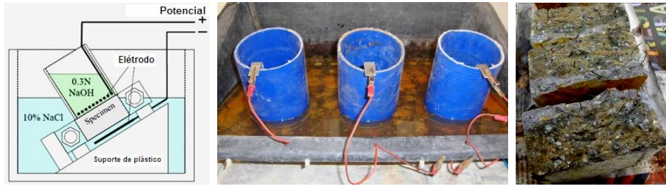
Figura 10. Ensaio acelerado de migração de cloretos
